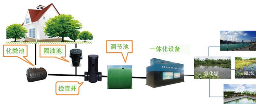
光大环保自主设计的农村污水一体化设备工作示意图
